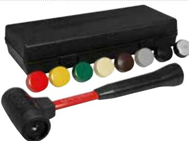
Estos martillos tienen dos características principales. La primera es que la deformación se da en la tapa y no en la pieza golpeada. Y la segunda característica consiste en que la cabeza es hueca y contiene cierta cantidad de granalla de acero, esta granalla sirve para disipar la vibración que se genera al momento de golpear evitando que el martillo rebote al dar un "golpe muerto".
