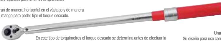
En este tipo de torquímetros el torque deseado se determina antes de efectuar la operación y al aplicar el torque se produce un sonido o click que es perceptible al tacto, indicando que se ha alcanzado dicho torque.
