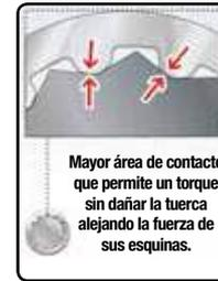
Mayor área de contacto que permite un torque sin dañar la fuerza de sus esquinas.
