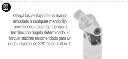
Otorga las ventajas de un mango articulado a cualquier mando fijo, permitiendo atacar las tuercas o tornillos con ángulo determinado. El torque máximo recomendado para un nudo universal de 3/8" es de 750 in-lb.
