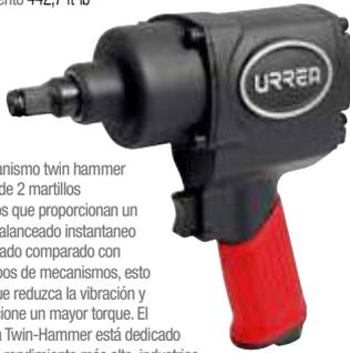
El mecanismo twin hammer consta de 2 martillos idénticos que proporcionan un golpe balanceado instantáneo y mejorado comparado con otros tipos de mecanismos, esto hace que reduzca la vibración y proporcione un mayor torque. El sistema Twin-Hammer está dedicado para un rendimiento más alto, industrias, servicios de neumáticos, servicios intensivos, aplicaciones de garaje y de montaje en el servicio.
