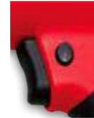
Botón de traba, evita daños en la superficie y da una mayor seguridad al operador, puede incrementar la calidad del atornillado, solo se puede activar si la manguera se encuentra conectada en la parte inferior.
