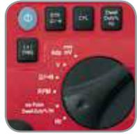
Funciones: Voltaje CD / CA, resistencia, RPM, ms-pulse, Dwell, % Duty cycle, frecuencia y continuidad.
