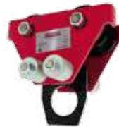
Un balero sellado por rueda. Argolla con resaque para colocar el polipasto. Eje principal con rondanas de ajuste para amplia gama de vigas. Chumacera soldada para mayor estabilidad. Perno central con ojal
