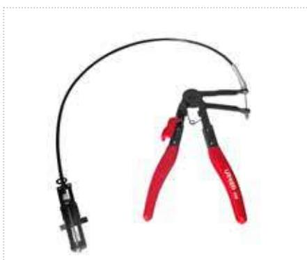
Para manipular abrazaderas autotensoras tipo resorte. Con bloqueo dentado. Para facilitar el cambio de mangueras de agua, aceite y combustible. Sujetador de abrazaderas con cable flexible de 630 mm.
