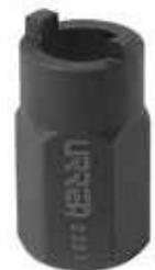
Para remover fácilmente la tuerca de la torre del amortiguador en automóviles VW® y Audi®. Puede ser usado con una llave de 7/8" (22mm) Fabricada en cromo molibdeno.
