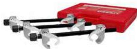
Comprime resortes en amortiguadores de suspensiones tipo McPherson en 3 puntas. Se puede utilizar con cuadro de mando de 1/2" o con dado de llave de 24mm. No se utilice con herramienta de impacto.
