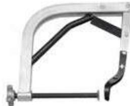
Para comprimir el resorte y sacar los retenes de las válvulas del motor.
