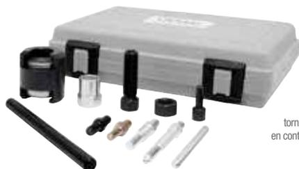
Remueve fácilmente los elementos de transmisión de potencia. Coloque la barra y las tuercas de instalación sobre la polea, ajuste de acuerdo al tornillo central y remueva girando en contra de la barra con la llave de estrías.
