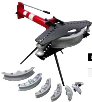
Sistema hidráulico monoblock, con retorno de pistón automático.
