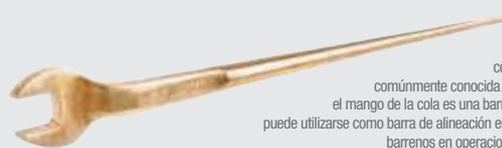
Estas llaves cuentan con una boca fija, comúnmente conocida como española, el mango de la cola es una barra cónica la cual puede utilizarse como barra de alineación en el centrado de barrenos en operaciones de montaje.
